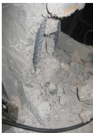
Φωτ. 2. Ρωγμάτωση τοιχίου T 5 μετά το τέλος του πειράματος.
