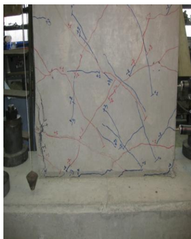
Φώτο 3. Λυγισμός ακραίων ράβδων οπλισμού τοιχίου T_2
