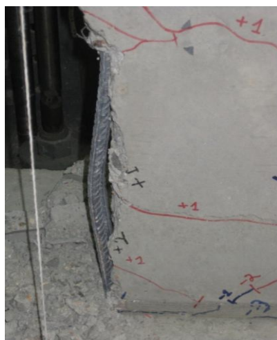
Φώτο 3. Λυγισμός ακραίων ράβδων οπλισμού τοιχίου T_2
