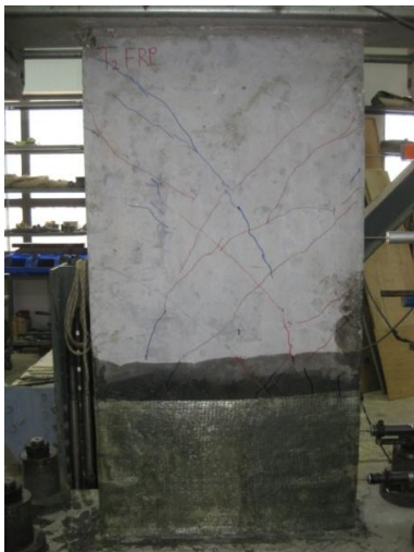
Φώτο 5. Αστοχία επισκευασμένου τοιχίου T 2 .
