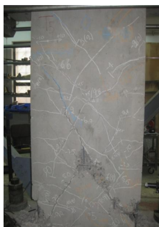
Φωτ. 2. Ρωγμάτωση τοιχίου T 5 μετά το τέλος του πειράματος.
