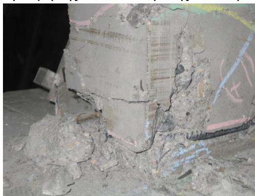
Φώτ. 1 Ρωγμάτωση τοιχίου T 1 μετά το τέλος του πειράματος.
