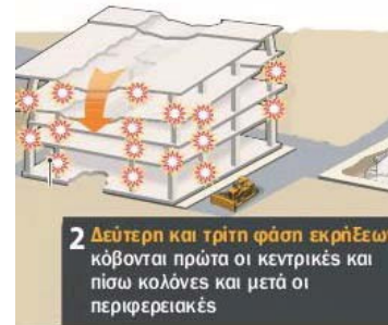
Σχήμα 12: 2 η - 3 η φάση κατεδάφισης
