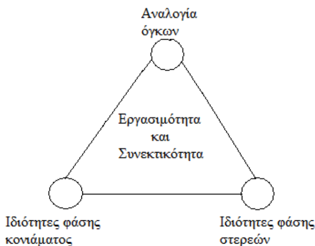
Σχήμα 1: Ιδιότητες των δύο φάσεων του SCC [4]
