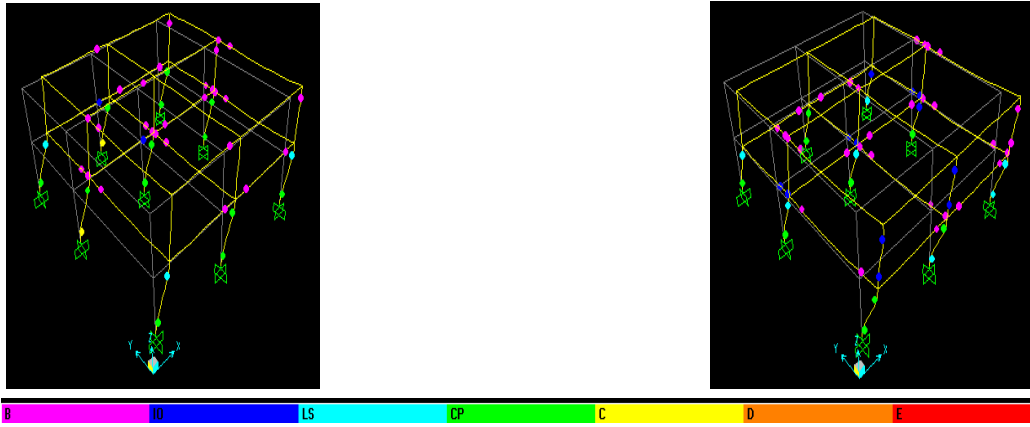
Σχήμα 5: Παραμορφωμένος φορέας υφιστάμενου κτιρίου για τη στοχευόμενη μετακίνηση (Διεύθυνση X και Y)
