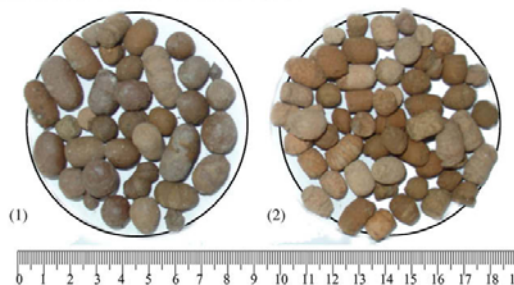
Σχήμα 4. Μορφή των δύο διαφορετικών παραγωμένων ειδών αδρανών (Wang, 2009) [8]
