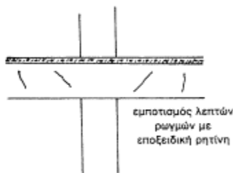
Εικόνα 12 : Συγκόλληση ρωγμών με χρήση εποξειδικής ρητίνης [4]
