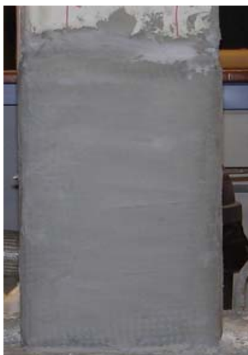
Εικ. 4: Τελική Επίστρωση με Τσιμεντοκονία [5]
