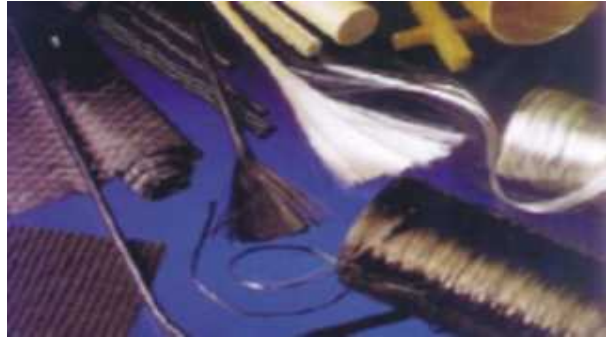
Σχήμα 2: Συνήθεις ίνες άνθρακα και γυαλιού και ινοπλισμένα πολυμερή (FRP) [2]
