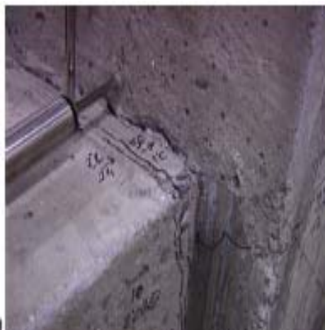
Φωτογραφία 8: Διαμητική αστοχία δοκιμίου WB-S1-U [5]
