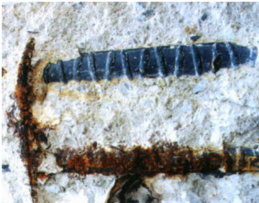
Σχήμα 1: Διάβρωση χάλυβα οπλισμού απο χλωριόντα [3]
