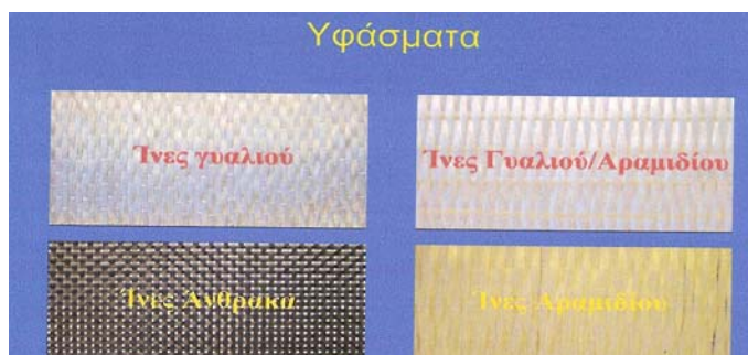
Σχήμα 3 : Ίνες Άνθρακα, Αραμιδίου, Γυαλιού και Γυαλιού / Αραμιδίου [14]
