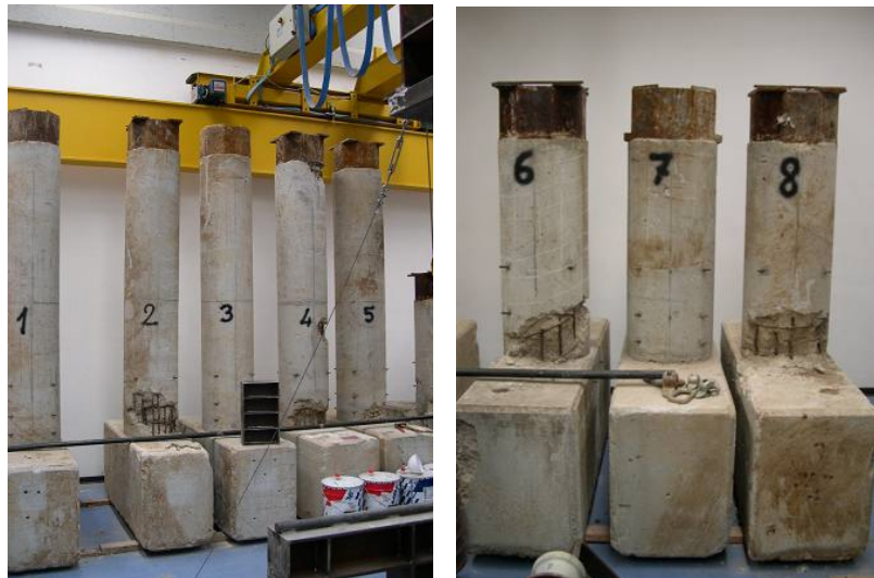
Εικόνα 1 – Υποστυλώματα σε κλίμακα ψηλά και κοντά [6]
