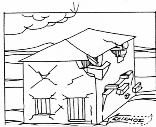
Σχήμα 1β: Αστοχία τοίχων (κατάρρευση) ανάλογα με τη διεύθυνση του σεισμού [3].
