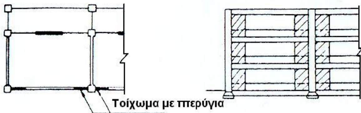
Σχήμα 7 : Προσθήκη τοιχώματος με πτερύγια εντός πλαισίου [9].
