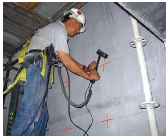
Σχήμα 17: Impulse-Response testing στην εσωτερική επιφάνεια των πάνελ. [14]
