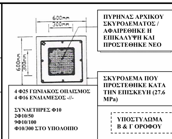
Σχήμα 12. Υποστύλωμα Β' και Γ' ορόφου [10] .
