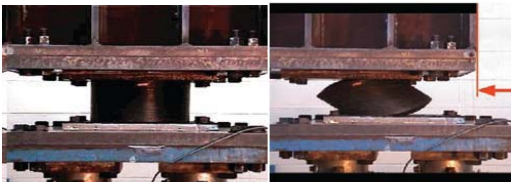
Σχήμα 6: αποσβεστήρας σε εργαστηριακές δοκιμές, με το κόκκινο βέλος στο δεξί τμήμα να ισούται με την μετατόπιση του κατά τη διάρκεια ενός σεισμού, [13].
