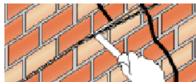
Εικ.12. Εισαγωγή ράβδου με βοήθεια καλεμιού [7]
