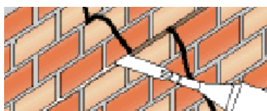
Εικ.13 Έγχυση παχύτερης στρώσης κονιάματος [7]
