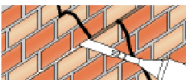
Εικ.11 Έγχυση πρώτης στρώσης κονιάματος [7]
