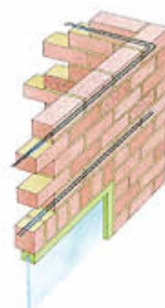
Εικ.21. Στροφή ράβδων σε γωνία [7]
