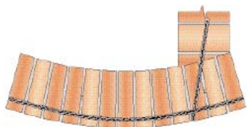
Εικ.32 Ενίσχυση και «δέσιμο» κοίλου τοίχου [7]
