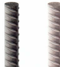
ΕΙΚΟΝΑ 2: Ράβδοι Συμβατικού (αριστερά) και Ανοξειδωτου Χάλυβα (δεξιά) [20]
