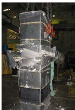
Σχήμα 3: Αστοχία υποστυλώματος ενισχυμένου με FRP [11]
