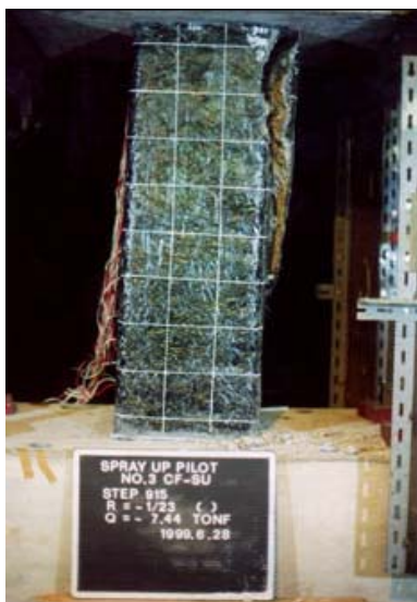
Εικόνα 4,5: Αστοχίες λόγω θραύσης των μανδύων από SFRP[3]
