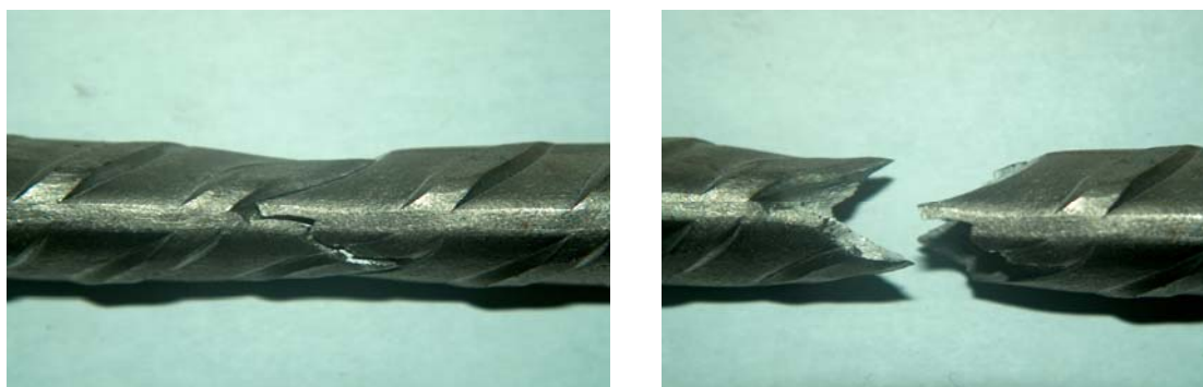
Εικόνα 2: Μακροσκοπική Παρατήρηση δοκιμής εφελκυσμού σε ράβδο Φ14. Δημιουργία μικρού λαιμού (αριστερά), περιοχή θραύσης (δεξιά). 3
