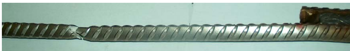
Εικόνα 3: Μακροσκοπική Παρατήρηση Συγκόλλησης κατά Παράθεση Ράβδου Φ14 (θραύση μακριά από τη συγκόλληση) 3
