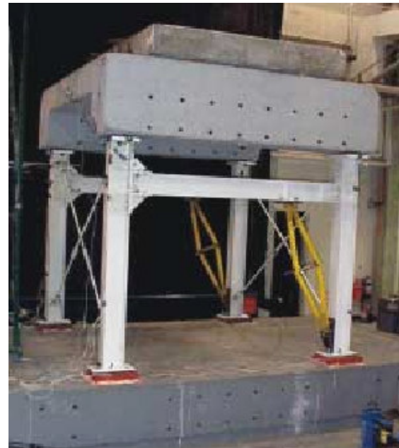
Σχήμα 4: Ομοίωμα διάταξης scissor – jack στον σεισμικό εξομοιωτή στο πανεπιστήμιο του Buffalo
