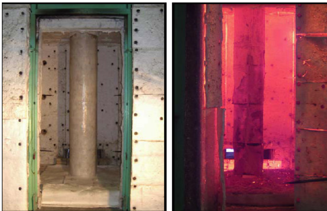
Εικόνα 2. Υποστήλωμα κυκλικής διατομής α) πριν και β) μετά την έκθεσή του στην πυρκαγιά. [7]
