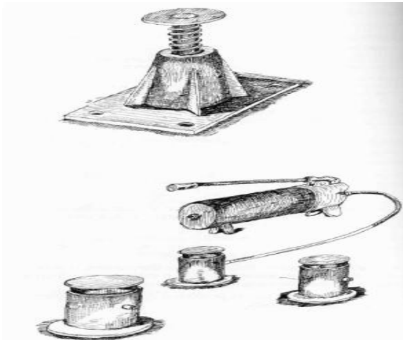
Σκ. 17. Μηχανικός - υδραυλικός γρύλος [1]
