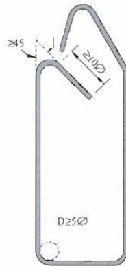
Σχ.3 : Γεωμετρικά στοιχεία μόρφωσης συνδετήρα
