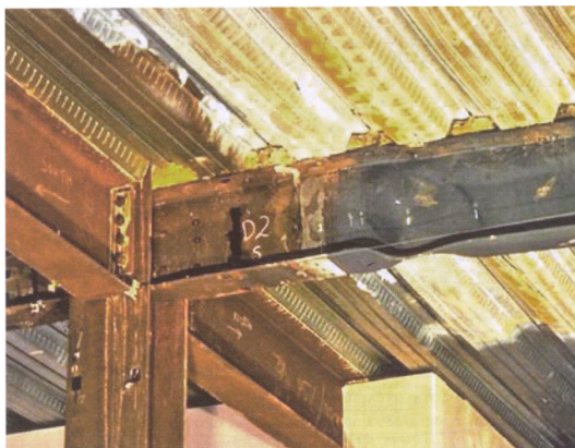
Σχήμα 7: Λυγισμός του πέλματος στη δεσμευμένη δοκό του πειράματος 1[6]
