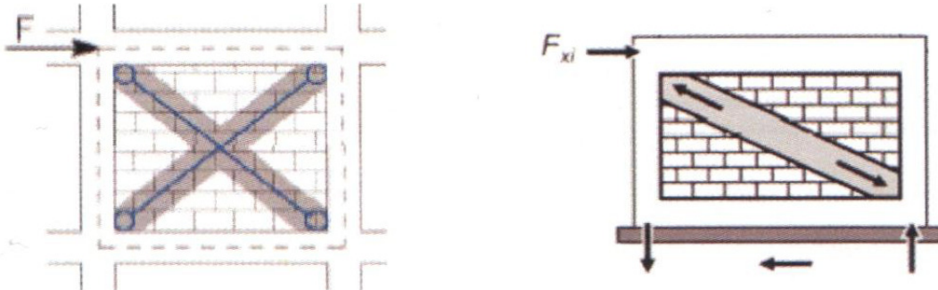
Σχήμα 2: Προσομοίωση τοιχοποιίας με την μέθοδο της θλιβόμενης διαγωνίου [3]
