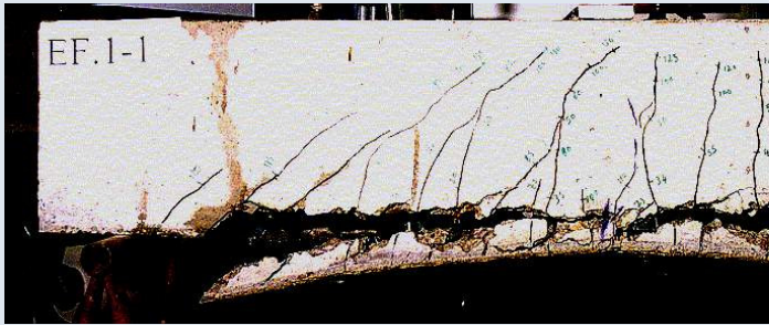
Απόσχιση επικάλυψης σκυροδέματος στο πέρας του σύνθετου υλικού Σ. Η. ΔΡΙΤΣΟΣ
