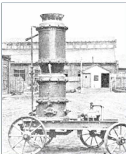
Εικόνα 1: Η πρώτη μηχανή εκτοξευόμενου Σκυροδέματος που χρησιμοποιήθηκε από τον Carl Akeley το 1907 (φώτο του J.J. Shideler, Portland Cement Association), [14]
